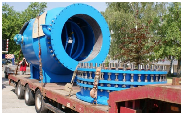
Per Tieflader kamen die neuen epoxidharzbeschichteten Armaturen DN 1800 zu ihrem Einsatzort.
